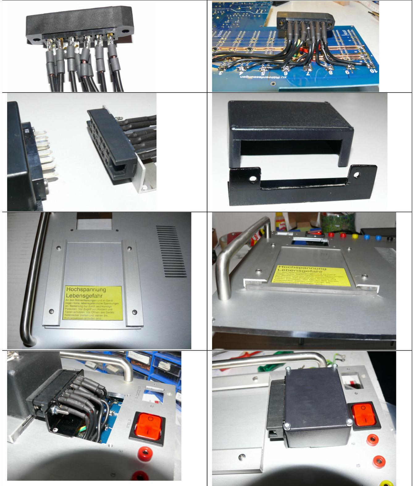
Der Fassungsboxhalter besteht aus Plastik (Bastlerglas) und einem Aluwinkel und hat zwei Führungsschienen, in welche die Fassungsboxen geschoben werden können (Maße siehe Zeichnung auf CD-Rom). Darauf achten, dass die Schrauben nicht auf der Rückseite der
