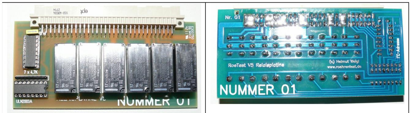
*Relaisplatine: Auf Rückseiten sind zur Adressierung der PCF8574(A) die Lötbrücken gemäß Tabelle zu setzen (beim fertigen Platinensatz habe ich die Brücken gleich im Herstellungsprozess gesetzt):*
