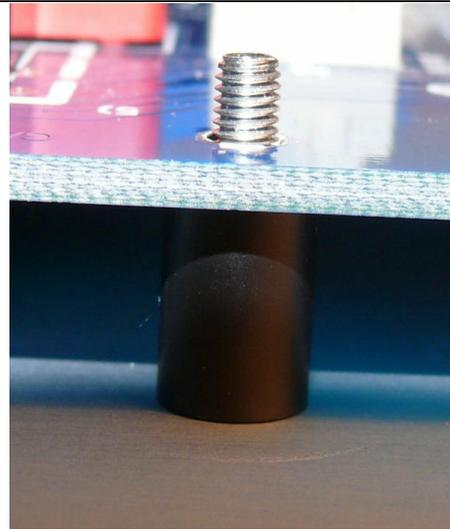
Gewindebolzen: Mittels Kunststoffdistanzrollen von 10 mm Länge (bei zentralem Masseanschluss Mefalldistanzrolle) wird die Hauptplatine auf der Rückseite der Frontplatte befestigt
