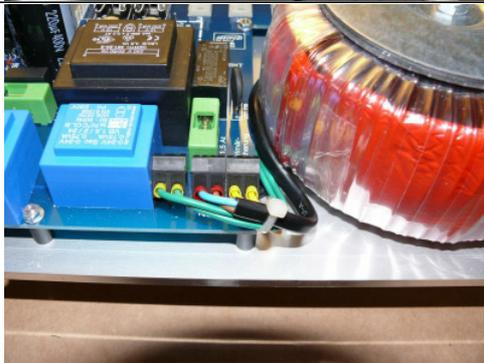
Die in der Nähe des Trafos gelegenen Hauptplattenanschlüsse habe ich auf der top-site eingebaut. Das Kabel für den Netzanschluss (Anschluß in der Mitte) habe ich wieder unterhalb der Hauptplatine verlegt. Ich habe dafür ein zweipoliges Netzanschlußkabel verwendet.
