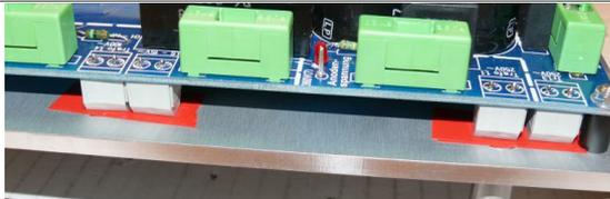
Damit es bei den auf der bottom-site eingelöteten Anschlussklemmen keine Kurzschlüsse oder Spannungsüberschläge zur Frontplatte gibt, habe ich noch eine Isolierung mit Klebeband angebracht (rot).
