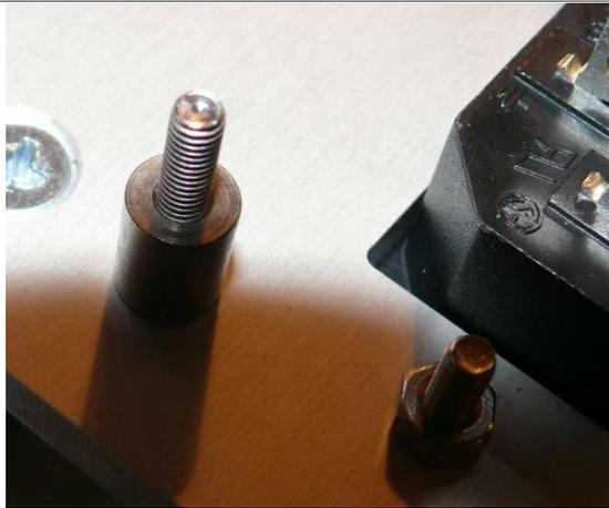
Der **zentrale Masseanschluß der Hauptplatine** wird über eine **Messing-Distanzrolle** mit der Hauptplatine verbunden. Die Netz-Erde ist mit der Frontplatte zu verbinden. Dadurch sind alle nach aussen führenden Metallteile, sowie (über die Messing-Distanzrolle) auch die Schaltungs-Masse mit Erde verbunden.
