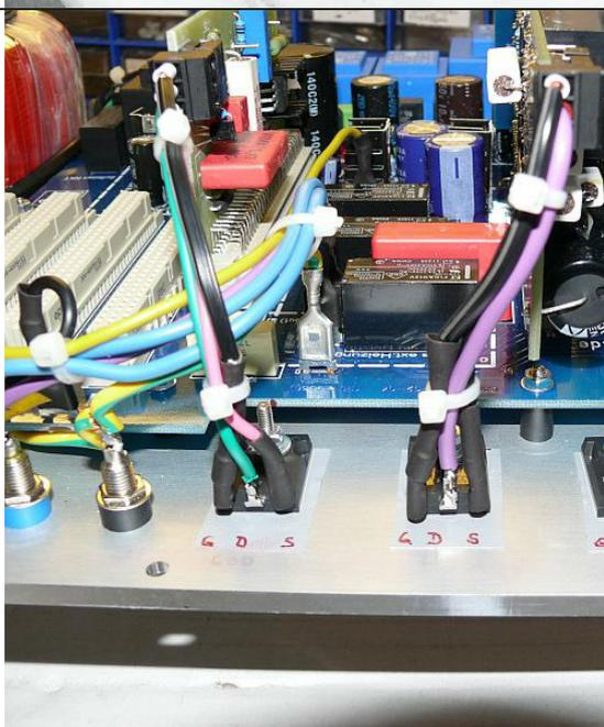
Die MosFet's sind natürlich isoliert zu befestigen (Silikonisolerfolie).
