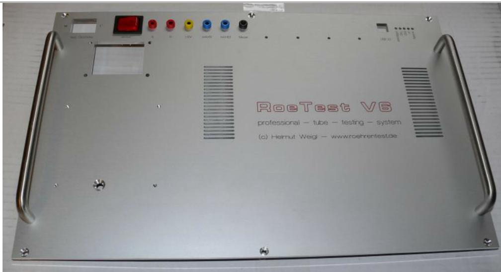
Die Edelstahlgriffe sind als normale Möbelbeschläge in Baumärkten erhältlich. Die Schrauben zur Befestigung auf der Rückseite sind zu versenken.
