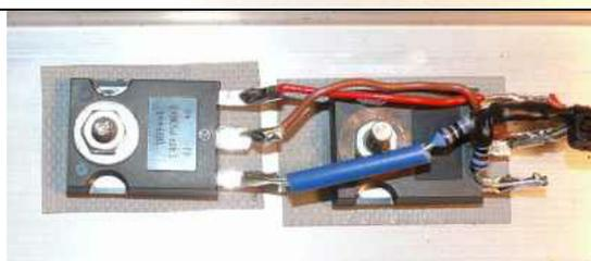
Für Heizspannung und Anodenspannung werden jeweils zwei MosFet's parallelgeschaltet. Source und Drain werden direkt verbunden. Die Gate-Anschlüsse werden über jeweils einen 4,7 K-Widerstand verbunden.
