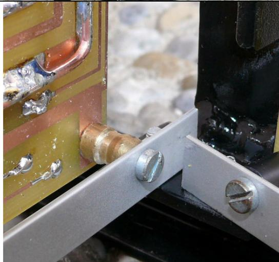
Erdung des zentralen Massepunktes auf der Hauptplatine! Der Massepunkt ist mit einem Metallabstandshalter mit der Aluschiene verbunden. Der Erdanschluß der Netzzuführung ist über Kabel mit diesem Massepunkt **und** über ein weiteres Kabel direkt dem Chassis verbunden.
