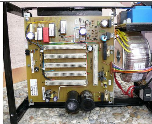
*Einbau der Haupt- platine (zwei Teile - Rückseite an Rückseite)*
