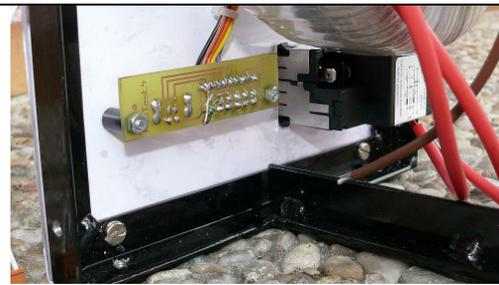
*Auf der Frontplatte sind Netzschluß (m. Schalter/ Si-Filter) und Anschlußplatte (LED's und USB- Buchse) angebracht, die Frontplatte ist mit den Griffen (Möbel- beschläge am Chasis befestigt.*
