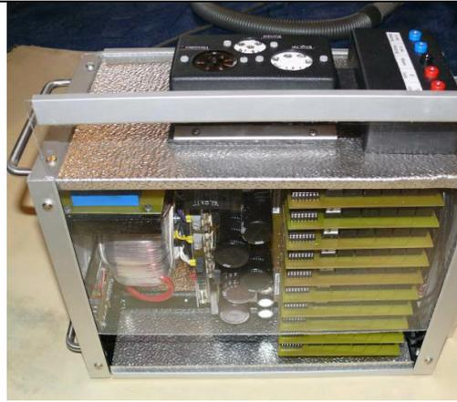
*Zwischen den seitlichen Aluschielen und dem Stahlchassis befindet sich ein Plastikstreifen, so daß sich eine Führungsschiene ergibt, in welche die Seitenteile eingesteckt werden können.*
