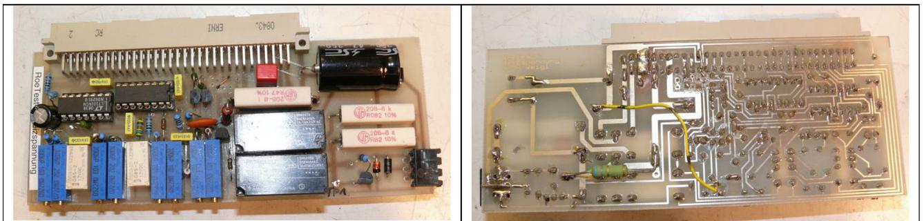
Der Messwiderstand RVunten setzt sich zusammen aus zwei übereinandergelöteten 0,47 Ohm/5W-Widerständen (parallel = 0,24 Ohm/10Watt insgesamt). Die Lötbrücke auf der Platinenrückseite nicht vergessen! Auf der Lötseite ist außerdem der für die Röhrenidentifizierung/Widerstandsmessung benötigte 6,8-Ohm/5W-Widerstand einzulöten.
