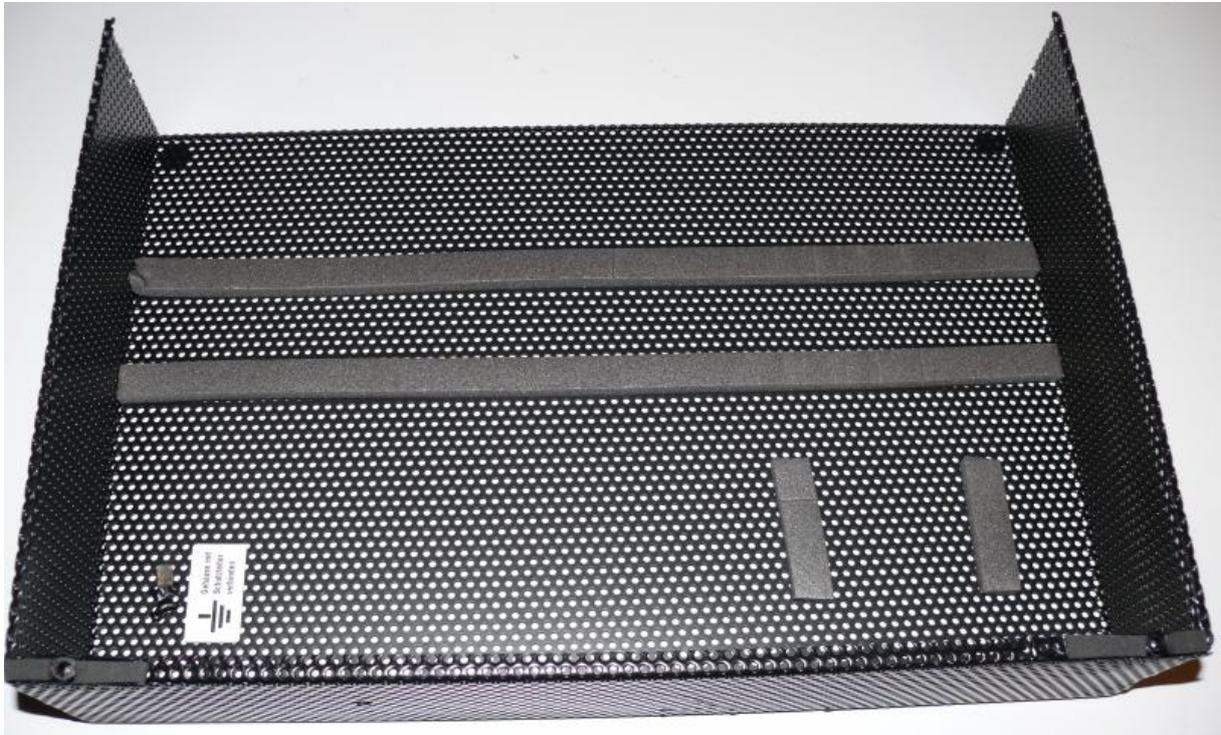
Selbstklebende Tüрдichtungsgummis dienen als Platinenhalter. Das Metallgehäuse ist mit Netzerde zu verbinden. Das Gehäuse wird mit 4 Stück M4-Schrauben an Frontplatte und Kühlkörper befestigt (zwei vorne oben, zwei hinten seitlich).
