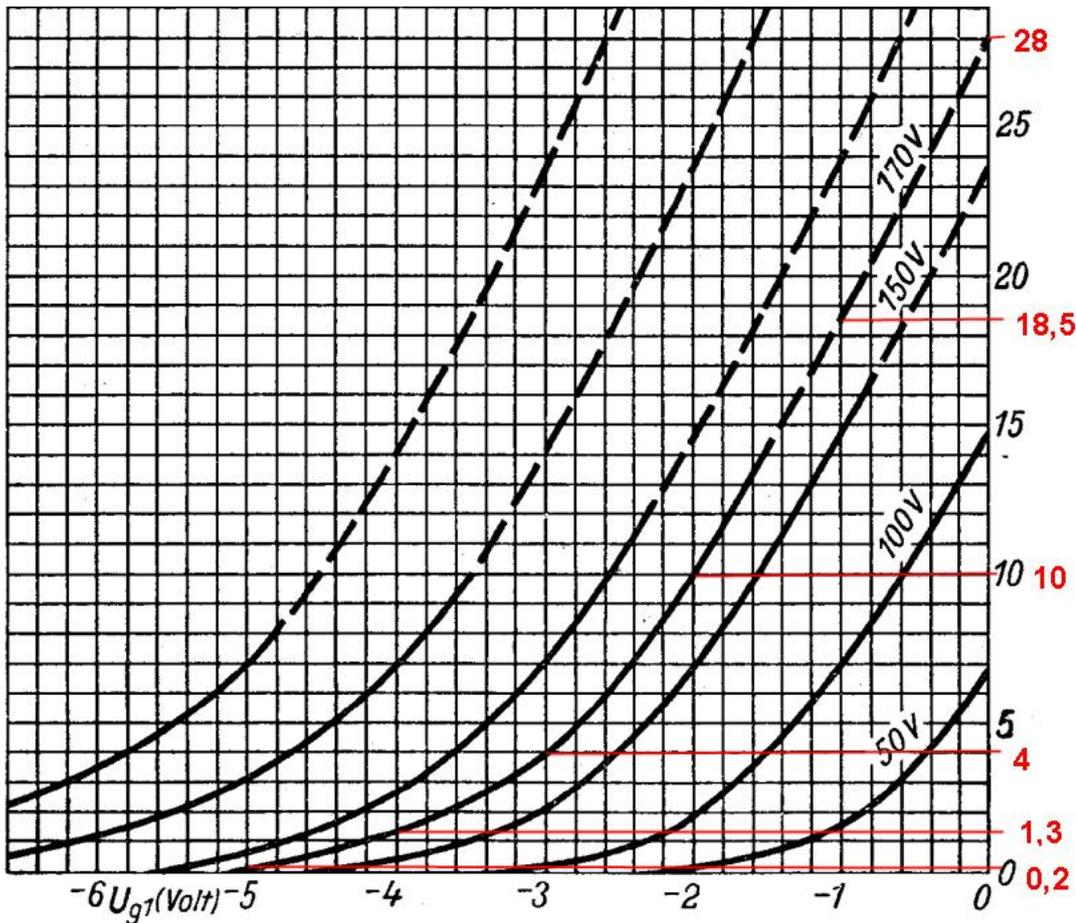
Im Auswertefenster unter "Kennlinien hinzufügen" werden die Wertepaare der Kennlinie erfasst (**rot markierte Felder**). Und zwar die Werte der X-Achse ("gesendete Spannung") von links nach rechts steigend. Nicht gefüllte Felder weisen die Werte 0/-99 aus. Eine Besonderheit gibt es zu beachten: Ein Anodenstrom von 0 mA wird nicht dargestellt. Man kann stattdessen einen sehr kleinen Wert (z.B. 0,01 mA) eingeben.
