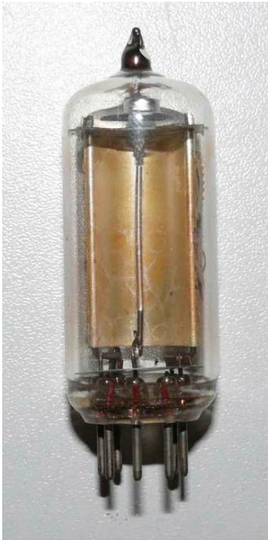
Die Röhre hat keine Heizung, sondern nur Anode und Kathode. Die Betriebsspannung beträgt 50V. Der maximale Strom 10 $\mu$ A.
