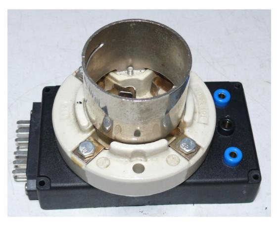
Die Anschlüsse sollten noch isoliert werden. An den Bananenbuchsen kann eine externe Heizung angeschlossen werden.
