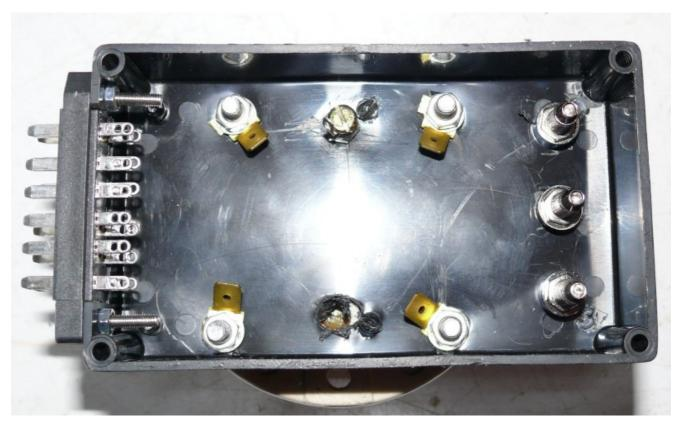
Die Fassungskontakte habe ich dann mit durchgehenden Schrauben und Lötfahnen befestigt. So kann man die Kontakte von unten anschließen und braucht keine Drähte auf der Außenseite der Fassungsbox verlegen. Auch der Metallkragen ist mit einer längeren Schraube versehen und kann so von unten mit Masse verbunden werden.
