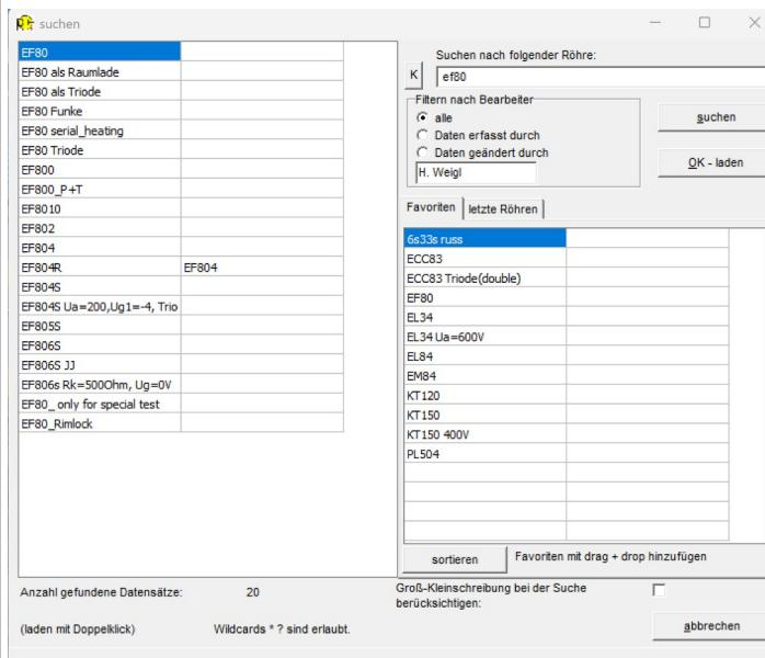
Tippen Sie in das Feld "Suchen nach folgender Röhre" die Anfangsbuchstaben der Röhrenbezeichnung (z.B. ef80) und die Return-Taste (oder den Button <suchen>). In der linken Tabelle werden alle Röhren aufgelistet, welche das Suchkriterium erfüllen.
