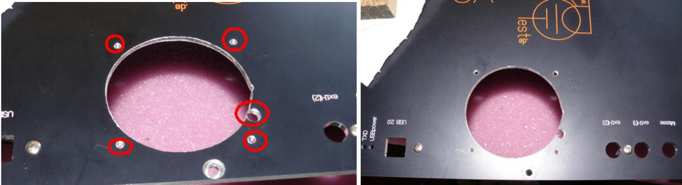
Der Lüfter mit Lüftergitter wird von oben auf die Frontplatte geschraubt. Die Blasrichtung des Lüfters ist, so dass die Luft nach oben herausgesaugt wird, was der natürlichen Konvektionsrichtung entspricht. Darauf achten, dass die Schrauben nicht hinter der Frontplatte herausstehen und die Hauptplatine berühren.
