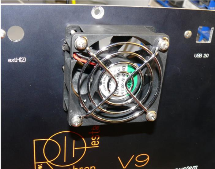
Der Lüfter wird an folgender Buchse der Hauptplatine (temperaturabhängig geschaltet per Software):
