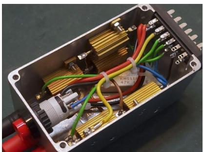
Als Fassungsbox habe ich mir zunächst nur eine für den Novalsockel gebaut. Die Löcher in der Bodenplatte lassen sich tatsächlich (siehe Tipp von Helmut Weigl) mit dem Box-Deckel gut positionieren. An der Abgleichbox ist es nicht leicht, die Löcher für die Befestigungsschrauben der Lastwiderstände richtig zu
