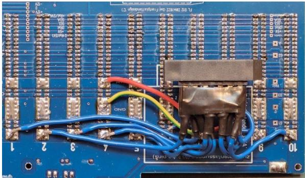
gefährlicher aus. Das Auflöten des Kabelbündels auf die Bottomseite der Hauptplatine war nicht ganz trivial: möglichst kurze Kabel mit großem Querschnitt und nur wenig Abstand zur Frontplatte. Aber mit einem Verbiegen, Kürzen und Verschieben ging auch das ohne Beschädigungen. Vielleicht nicht die schönste Montage, aber sie funktioniert.
