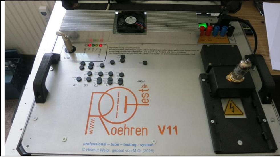
Fertiggestellte Oberseite und Probetrieb mit dem ersten Röhrentest
