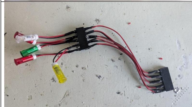
Das Anschlusskabel für die LEDs.
