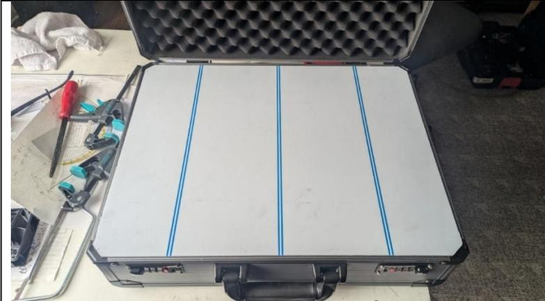
Dadurch, dass der Koffer 45-Grad Ecken hat, mussten die Aluplatten entsprechend angepasst werden. Das war mir vor dem Kofferkauf nicht aufgefallen.
