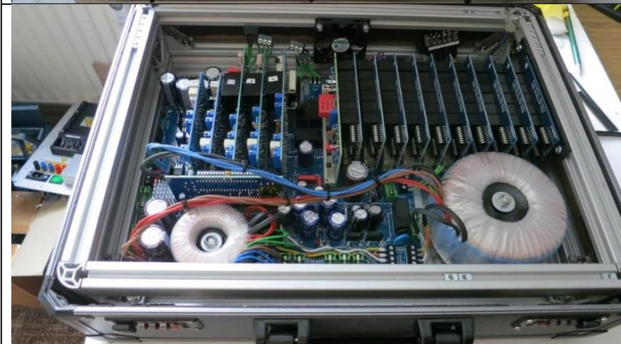
Trafos und Lüfter fertig montiert.
