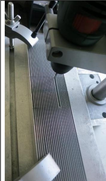
Bedingt durch die geringe Höhe des Kofferdeckels, war kein Platz den Lüfter auf den Kühlkörper zu setzen. Daher mußte eine Aussparung gefräst werden.
