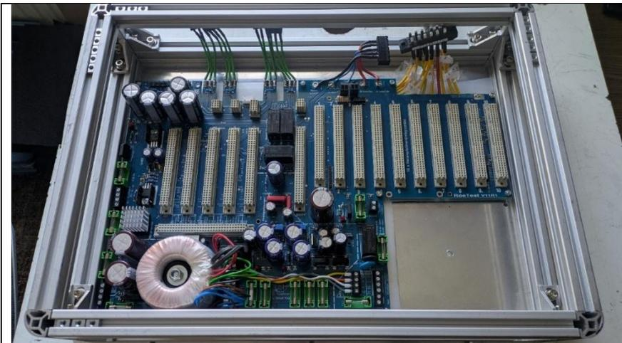
Einbau und Verschraubung der Hauptplatine auf der Bodenplatte.
