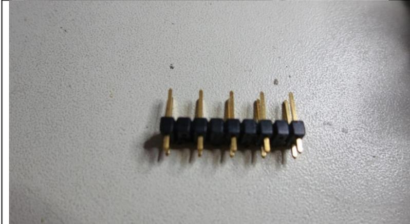
Für die Anzeige-LEDs wurde eine Stiftleiste präpariert, so dass auch diese Verbindung steckbar ist.
