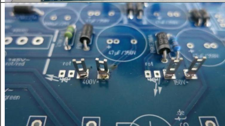
Für die Testpunkte wurden Testpins eingelötet. Das vereinfacht das Messen beim Abgleich
