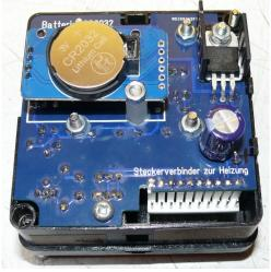
Auf der Rückseite der fertige Uhrenbaustein (billig bei Ebay) mit leicht auswechselbarer Stützbatterie, welche Jahre hält. Auf der Vorderseite die Elektronik mit aufsteckbarem OLED-Display und 3 Tasten zur Einstellung von Uhrzeit und Schaltzeiten. Die Leiterplatte wurde so gestaltet, dass Sie genau in das entkernte alte Uhrengehäuse passt.
