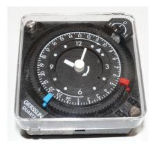
Für den Stromausfall enthält die Uhr einen Akku. Leider hält dieser Akku nur ein paar Jahre. Ein Auswechseln ist für den Laien schwierig, da die Platine der Uhr abgelötet und ein passender Akku neu eingelötet werden muss.
