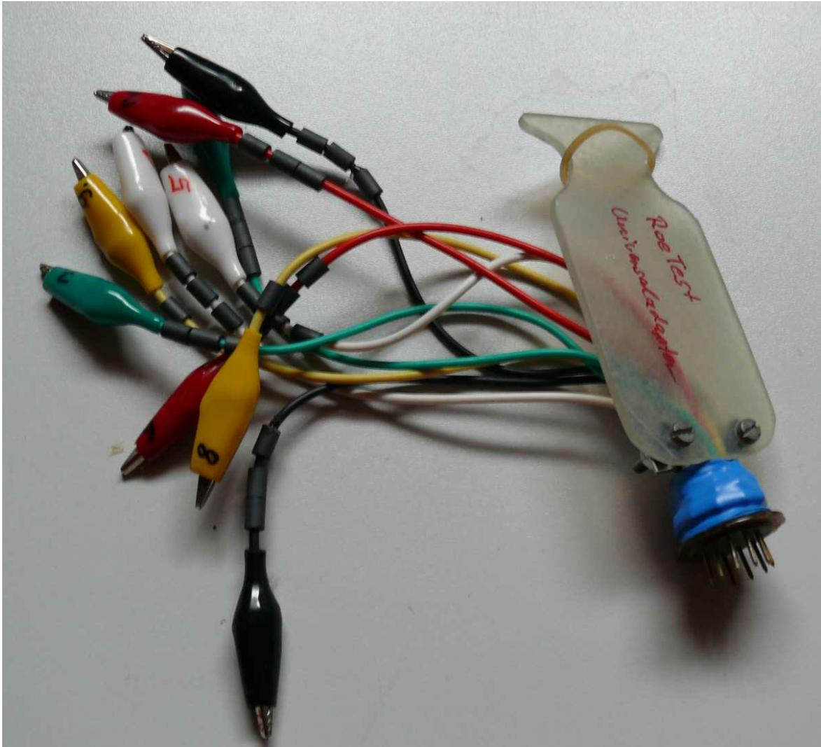
Ein Dekalstecker wurde mit kurzen Kabeln und Krokodilklemmen versehen. An den Stecker wurde ein Griff aus Plastik geschraubt. Der Adapter lässt sich so leicht aus der Fassung ziehen. Außerdem kann man die Röhre mittels eines Gummiringes am Griff befestigen. Sämtliche Kabel wurden mit Feritperlen versehen um Schwingneigung zu unterdrücken.
