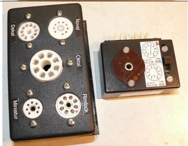
nicht alle Fassungsboxen müssen die gleiche Größe haben. Wird nur eine kleine Fassung eingebaut, kann auch ein kleineres Gehäuse verwendet werden, wie hier für die Gnomröhren (Gehäuse Reichelt Geh KS 35)
