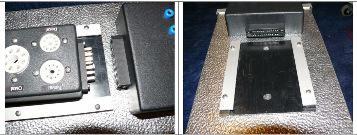
Das Gehäuse für den Anschluß ist ein Standardplastikgehäuse, bei dem der Boden weggelassen wurde. Für die Fassungsboxen wurde eine Führungsschiene aus Plastik- und Alustücken gebaut.
