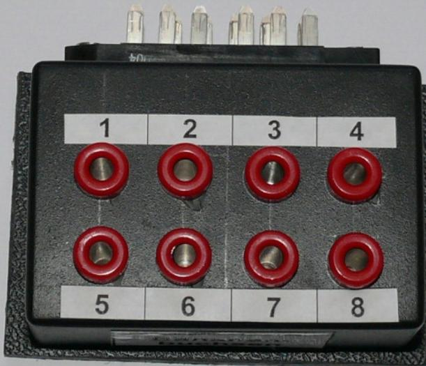
Bananenbuchsen (Anschluß 9 und 10 sind bereits am RoeTest eingebaut und brauchen in der Fassungsbox nicht nochmal eingebaut werden).
