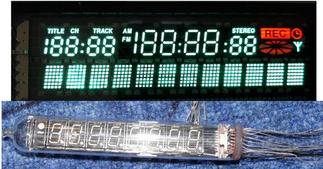
Die VFD's sind einfach zu testen. Der Faden wird beheizt. Alle Anoden und das Gitter an eine positive Spannung gelegt. Die Segmente müssen dann alle gleich hell leuchten. Heiz- und Anodenspannung kann aus den jeweiligen Datenblättern entnommen werden.
